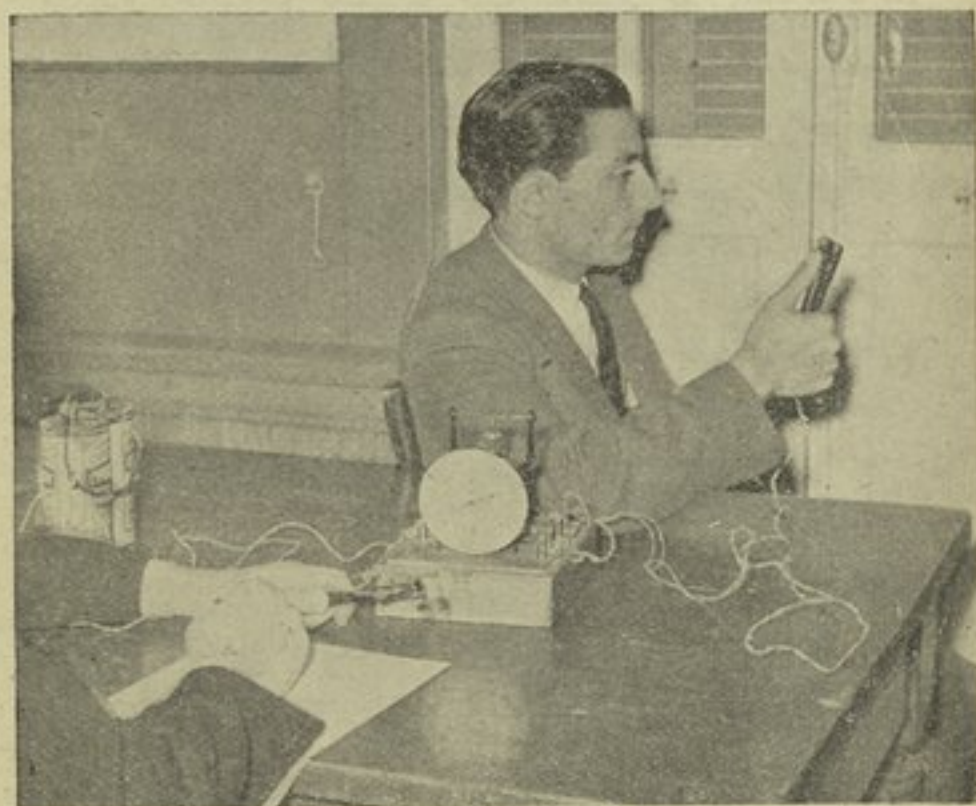
شكل ٣ - جهاز الكرونوسكوب أو « المزمان » لتسجيل زمن الرجوع ( معمل علم النفس بكلية الآداب بجامعة فؤاد الأول )
